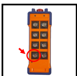
10 Start de zender op. (Druk 1x kort en 1x lang op start.)
